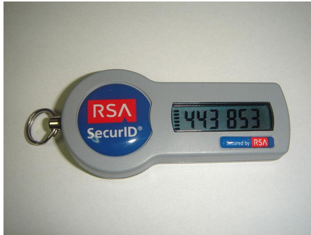
Abbildung 2: Standalone-OTP-Generator der Firma RSA Inc.
