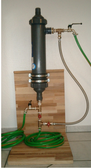
Abb. 38: Ultrafiltrationsanlage zum Ziehen von Trinkwasserproben (Eigenbau)
